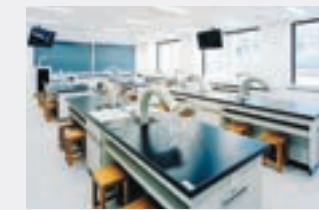
8 化学実験室 (校舎4階) 実験台ごとに排気装置を設け、安全性に配慮した実験室。
